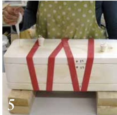
5 Squeezing slip into pour holes using an ear syringe to fill the pour holes.
