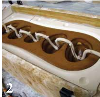
3 Pouring slip into the pour holes using funnels.
